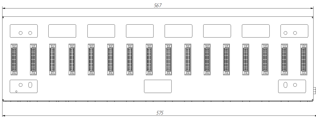
Рисунок А. 5 - Габаритные и присоединительные размеры шасси SH-16
